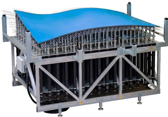
تصویر ۶. قالب سازگار شونده محصول شرکت Adapa. مأخذ: www.Adapamoulds.
