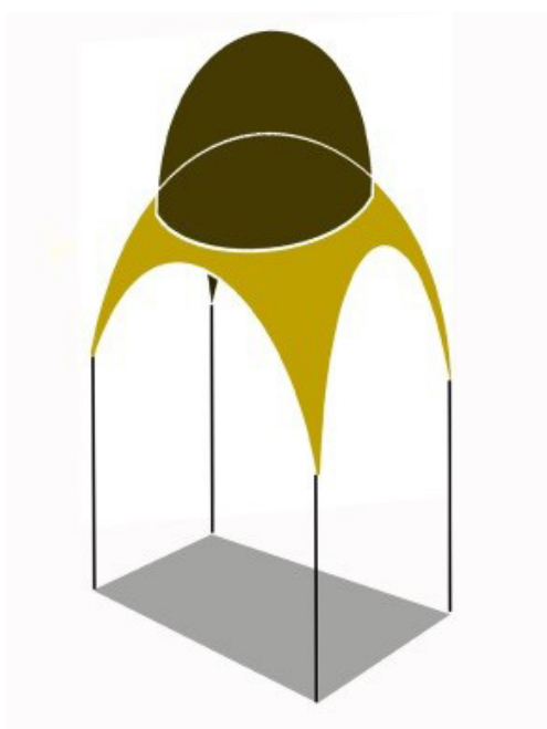
تصویر ۷. پوسته داخلی گنبد در روش استفاده از طاسچه. مأخذ: نگارندگان.
